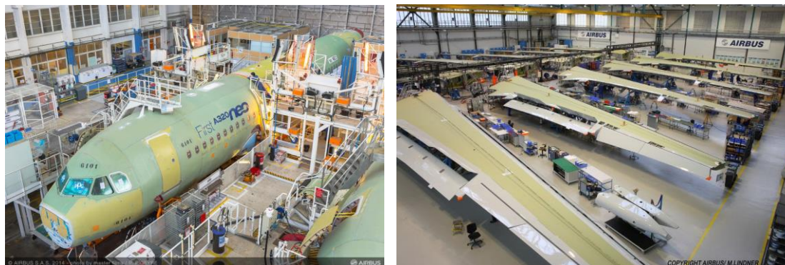
Abbildung 1: Flugzeugfertigung: A320neo in der Final Assembly Line. (Airbus, 2014)(links), Tragflächenausrüstung im Airbus Werk Bremen (Airbus, 2013)( rechts)
