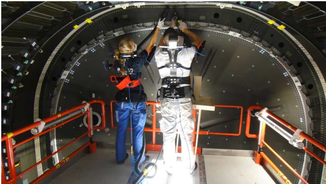
Abbildung 5: Test des Arm-Unterstützungssystem in der Flugzeugproduktion (Foto Airbus)
