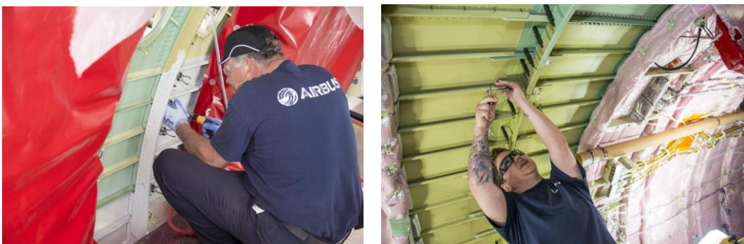
Abbildung 3: Typische Körperhaltungen bei der Rumpfmontage. (Airbus 2016a; Airbus 2016b)
