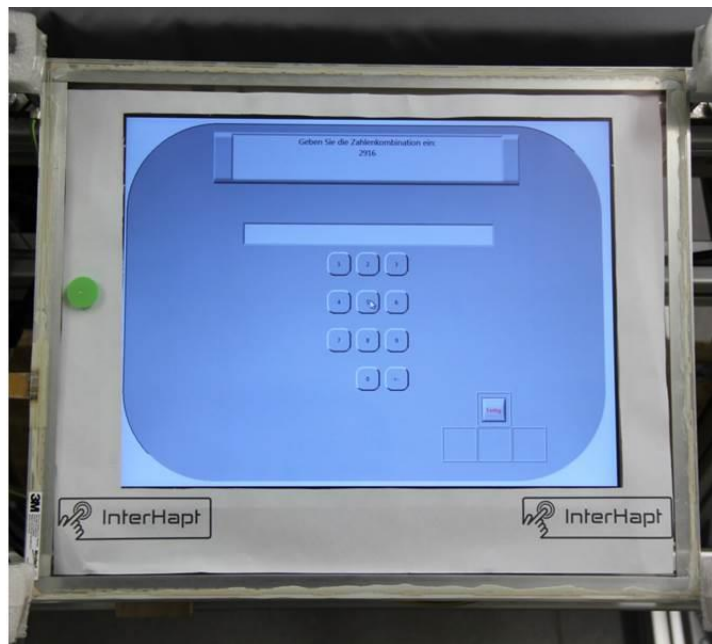
Abbildung 1: Versuchsaufbau zur Untersuchung der typischen Fingerkräfte auf einer Touchscreen-Oberfläche bestehend aus Rahmengestell (links) und Touchscreen (rechts)
