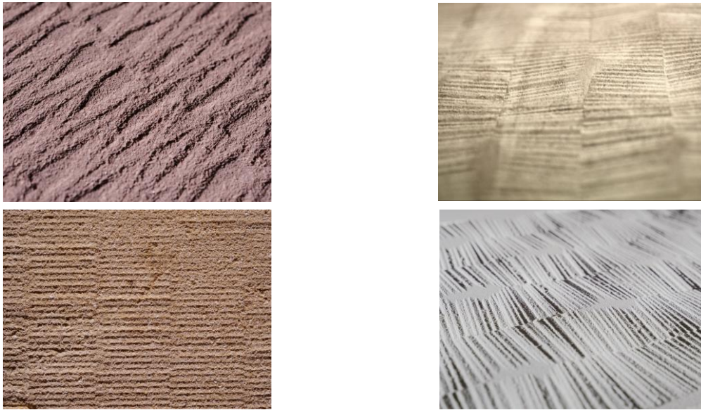
Abbildung 1: Beispiele für automatisiert scharrierte Oberflächen auf unterschiedlichen Steinsorten
