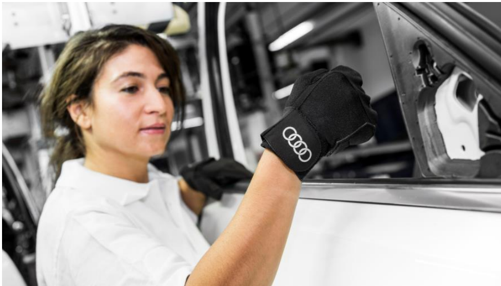
Abbildung 4: Produktionsorthese in der Türevormontage
