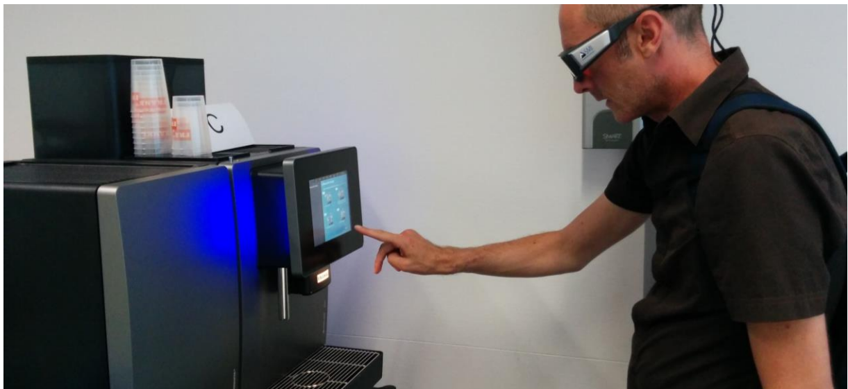
Abbildung 1: Nachgestellte Szene einer Testperson, welche während der Interaktion mit einem Kaffeevollautomaten (im Bild Modell C) einen mobilen Eye Tracker trägt.
