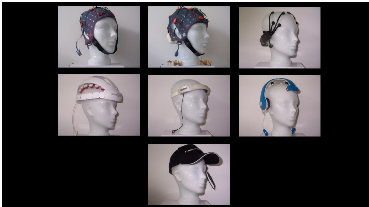
Abbildung 1: Die in der Studie benutzten EEG-Systeme (von links oben nach rechts): Ladybird, Sahara, EPOC, Trilobite, Jellyfish, BR 8 plus und MindCap.
