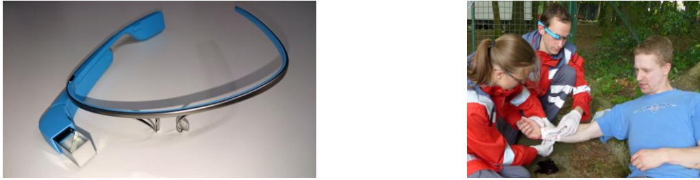
Abbildung 1: (links) Google Glass. Touchpad, Kamera und Prisma sind in dieser Ansicht links in den dickeren Brillenbügel bzw. Steg integriert (Mentler et al., 2015), (rechts) Präklinisches Einsatzteam mit Nutzer der Google Glass bei der Patientenversorgung
