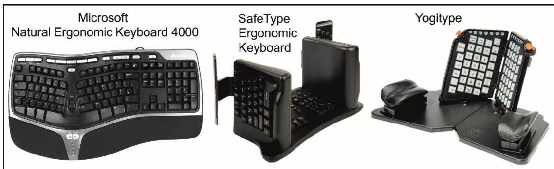
Abbildung 1: Untersuchungsgegenstände: Microsoft Natural Ergonomic Keyboard 4000 (links) sowie die Vertikaltastaturen SafeType Ergonomic Keyboard (Mitte) und Yogitype (rechts).
