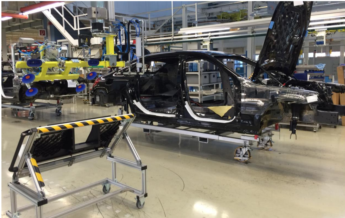
Abbildung 3: Handhabungsgerät an der Montagestation Schutz Fahrgastzelle
