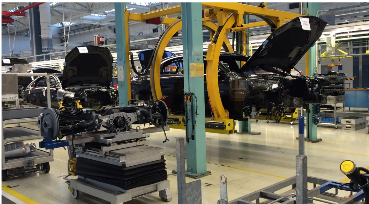
Abbildung 4: Arbeitsplatzgestaltung Montagestation Motor/Achsen
