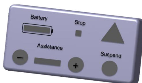
Abbildung 2: CAD-Modell des Bedienpanels für den linken Arm (Abmaße: 120 x 60mm) als schematische Darstellung der Positionen der Bedienelemente und Anzeigen
